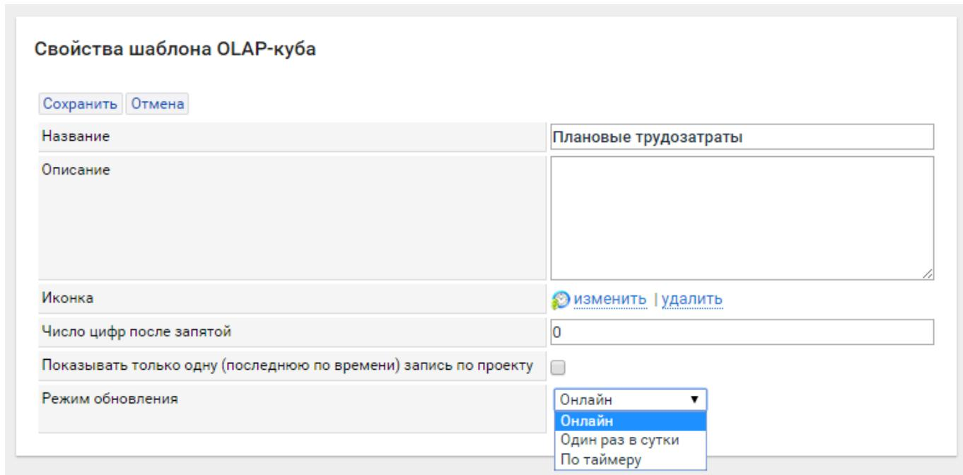
**Рисунок 1** – Настройка режима обновления OLAP-куба
